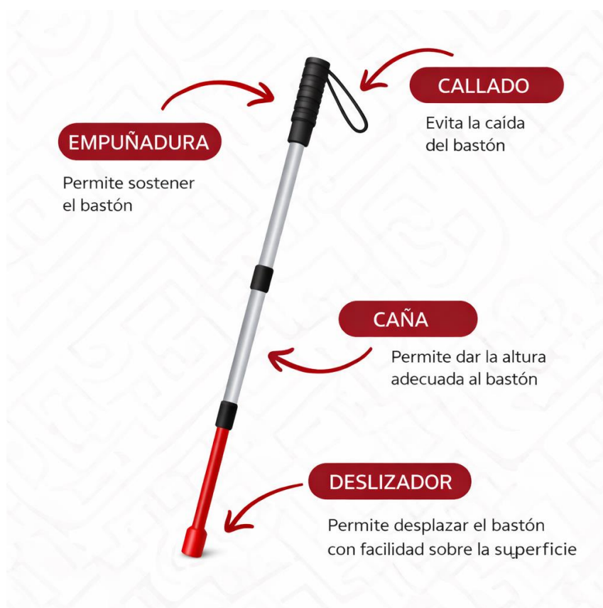
Figura 20: Partes de un bastón guía para personas ciegas
