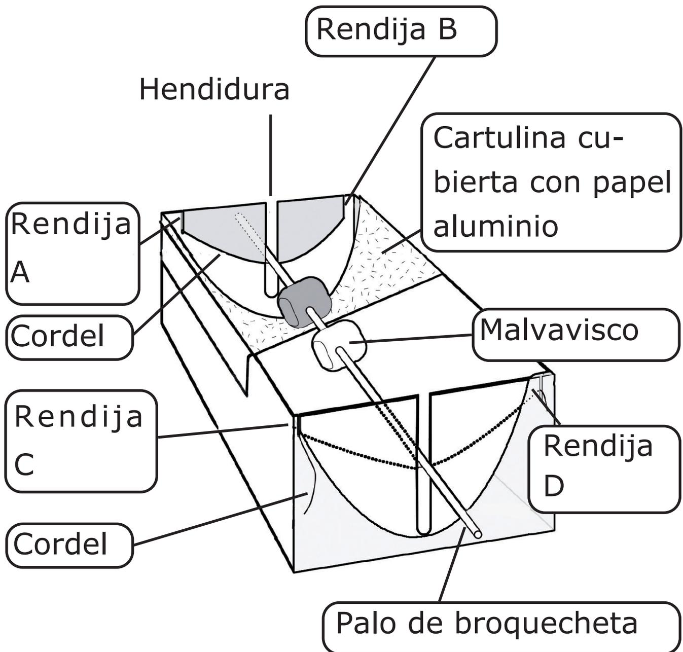
**5.** Coloquen el palo de brocheta con los malvaviscos en la hendidura, de modo que uno de ellos quede en la zona cubierta con papel aluminio y el otro en la parte del cartón de la caja. Los extremos del palo de brocheta deben descansar sobre los cordeles.
